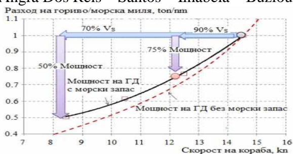
Фигура 2. Влияние на намаляването на скоростта върху разхода на гориво за проплавана миля
