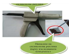
Общ изглед на обекта на изследване изгледане на репликите : а) долен лагерен полупръстен; б) реплика; в) шийка на колян вал
