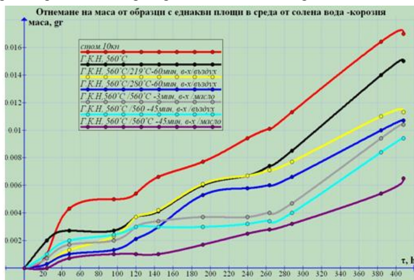
Фиг.7.12. Криви от корозионните изпитвания на стомана 0,8кп карбонитрирана и подложена на допълнителна термообработка
