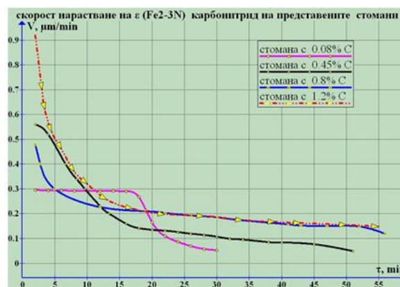
Фиг.4.11 Изследване кинетиката и скоростта на нарастване на КНЗ при температури на ГКН 570°C на стомани със съдържание на въглерод 0.08%, 0.45%, 0.8%, 1.2%:
