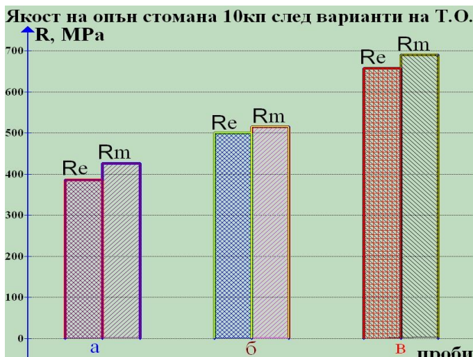
Фиг.7.6. Диаграми от изпитване на опън на стомана 10кп:
