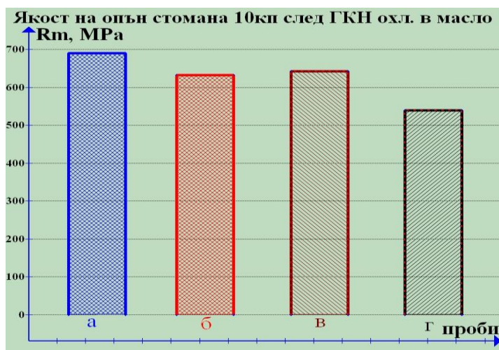
Фиг.7.5. Диаграми от изпитване на опън на стомана 10кп след ГКН при стайна и повишени температури:
