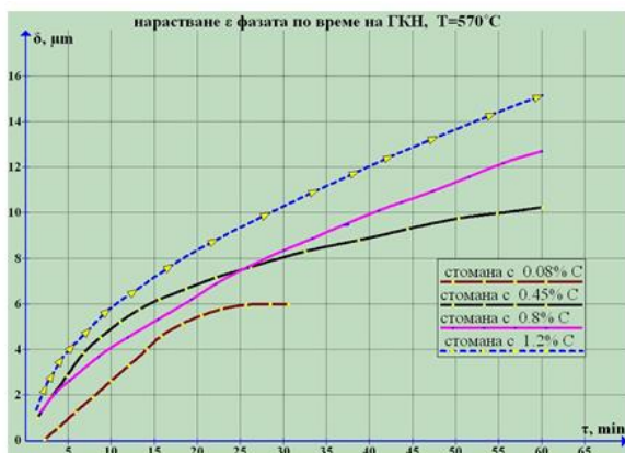
Фиг.4.11 Изследване кинетиката и скоростта на нарастване на КНЗ при температури на ГКН 570°C на стомани със съдържание на въглерод 0.08%, 0.45%, 0.8%, 1.2%:
