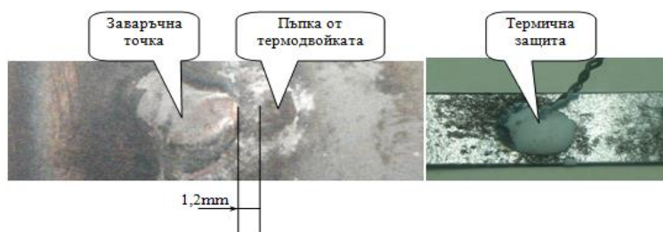
Фиг.6.2. Място на закрепване и термична защита на термодвойката
