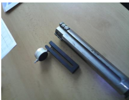
Фиг.5.4. Динамометрична скоба с инструмент за комбинирана обработка
