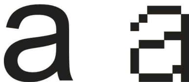
Фиг. 1.2 Буква а с шрифт Arial и кегел на шрифта 12 рх, показващ разликата между печатния векторен вариант на буквата (резолюция 300 dpi) и растеризирането на знака на екран (резолюция 72 ppi)
