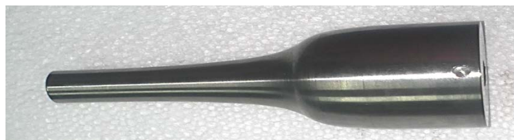
Фиг. 6.15. Сонотрод след повърхностно плазмено азотиране
