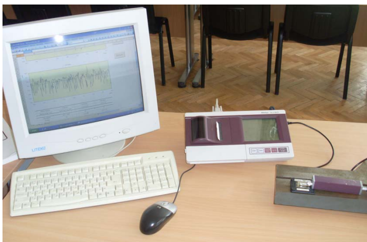
Фиг. 5.8. Установка за измерване на грапавост Mitutoyo SurfTest SJ301
