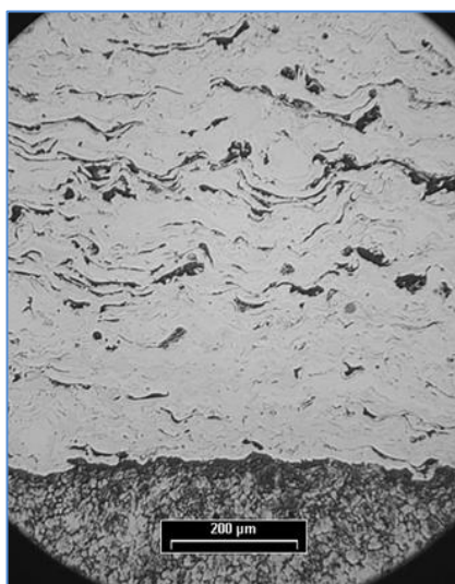
Фигура 4.3. Структура на покритието при режим P2 ( I_T=300A )
