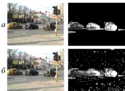
Фиг.3.26. Сравнение на резултатите от детекция на движение при: а) некомпесиран и б) компресиран видео сигнал. Дневен запис.
