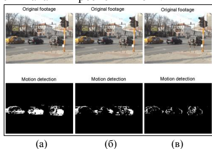
Фиг. 2.3. Метода на времево осредняване изпълнен за три стойности на \alpha , (а) \alpha=0.01 ; (б) \alpha=0.1 ; (в) \alpha=0.8 ;
