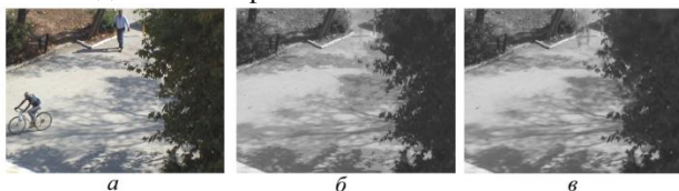
Фиг.4.23 Детектиране при динамичен фон. а) оригинален кадър; фонові модели на: б) оригинален ФОВ; в) Вариант А и Б.
