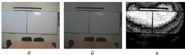
Фиг. 3.19. Кадри от тестовия видео запис преди и след промяната на осветлението, и кадър представящ грешно позитивните пиксели.
