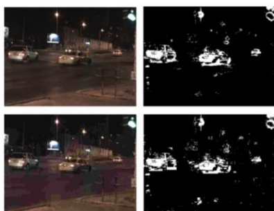
Фиг.3.27. Сравнение на резултатите от детекция на движение при: а) некомпесиран и б) компресиран видео сигнал. Нощен запис.
