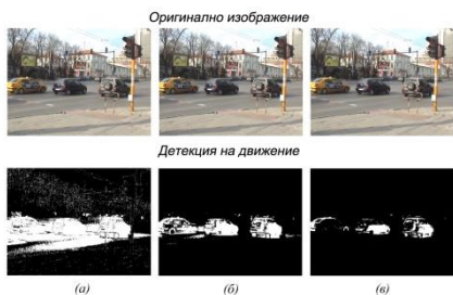
Фиг. 2.8. Метода АМФ изпълнен за три стойности на T , (а) T=5 ; (б) T=30 ; (в) T=70 ;
