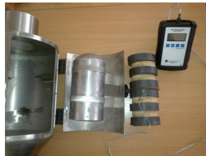
Фиг 3.7. Сепаратор с постоянни магнити тип MCR5 с добавени немагнитни междини
