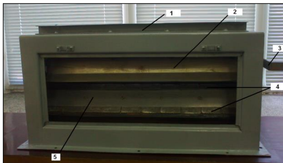
Фиг.2.1. Принципна схема на сепаратор с постоянни магнити тип WM-50C 1 – контейнер за обработван материал; 2 – шибър; 3 –ръкохватка; 4 – система от постоянни магнити; 5 – алуминиев разделител
