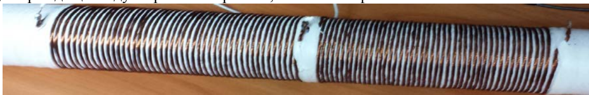
фиг.5.16. Общ вид на двете бобини L_{k1} = L_{k2} , изграждащи индуктора
