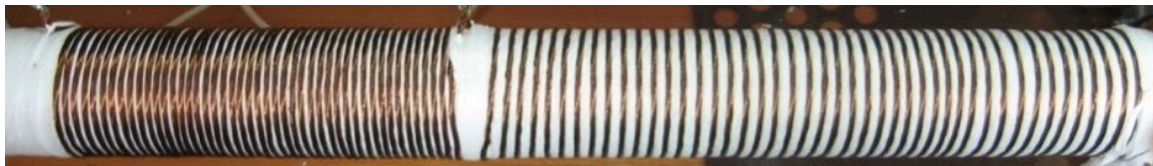
фиг.5.17. Общ вид на двете бобини L_{k1} \neq L_{k2} , изграждащи индуктора
