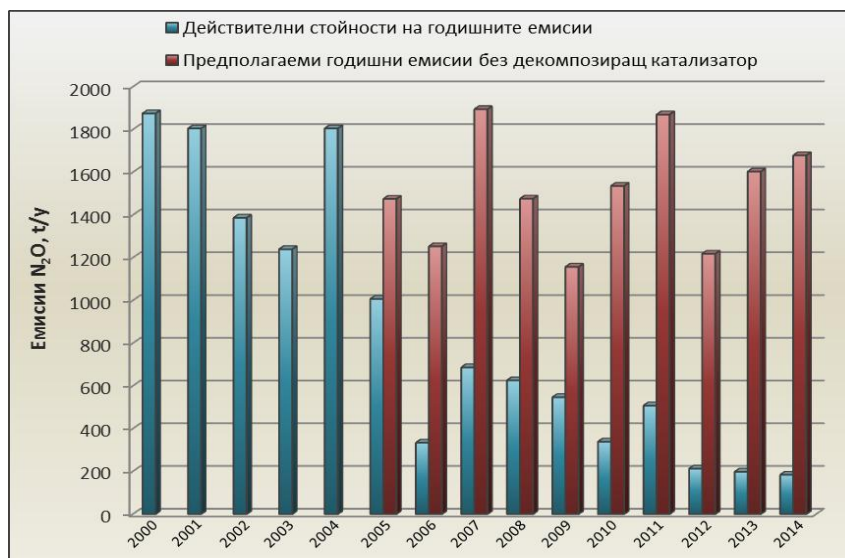
Фиг. 2.1. Емисии N_2O t/y за периода 2000 г. – 2014 г. с и без наличие на вторичен декомпозиращ катализатор
