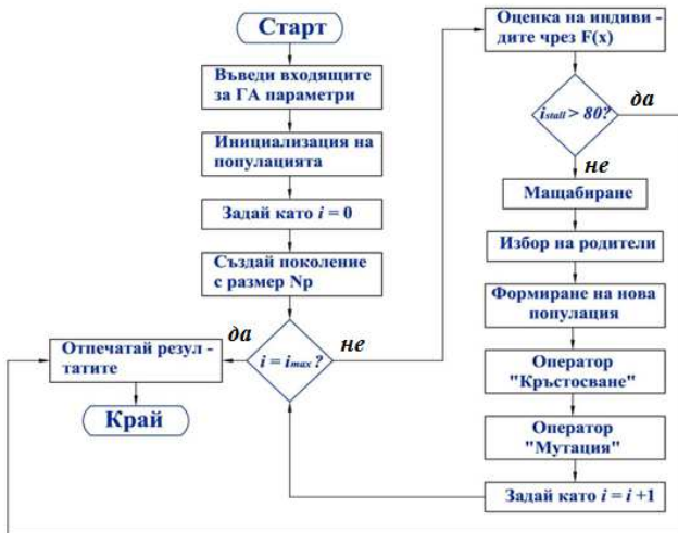
Фигура 2: Блок – схема на използвания генетичен алгоритъм
