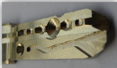
Фиг. 6.4.5. Нарязан секрет тип „вълнообразен канал” със нов инструмент
