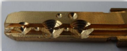
Фиг. 6.4.4. Нарязан „ямков секрет“ със износен инструментта
