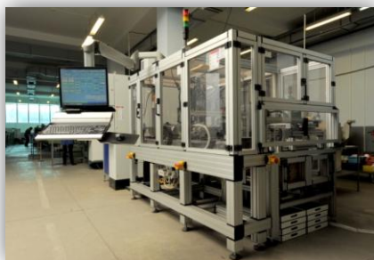
Фиг. 4.1. Машина за нарязване на профилен механичен шифър тип “ямков секрет” и тип “вълнообразен канал” на ключове за секретни ключалки ”
