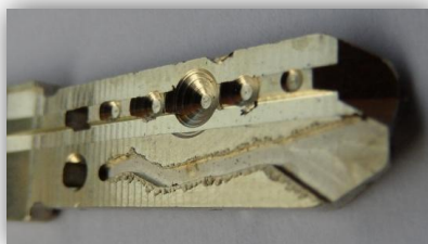
Фиг. 6.4.7. Нарязан секрет тип „вълнообразен канал” със износен инструмент
