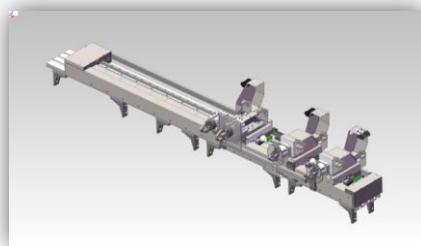
Фиг. 2.8.1. 3D модел на „Линеен манипулатор”
