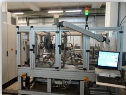
Фиг. 4.1. Машина за нарязване на профилен механичен шифър тип “ямков секрет” и тип “вълнообразен канал” на ключове за секретни ключалки ”
