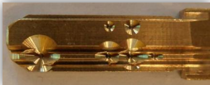
Фиг. 6.4.1. Нарязан „ямков секрет“ със заточен инструмент
