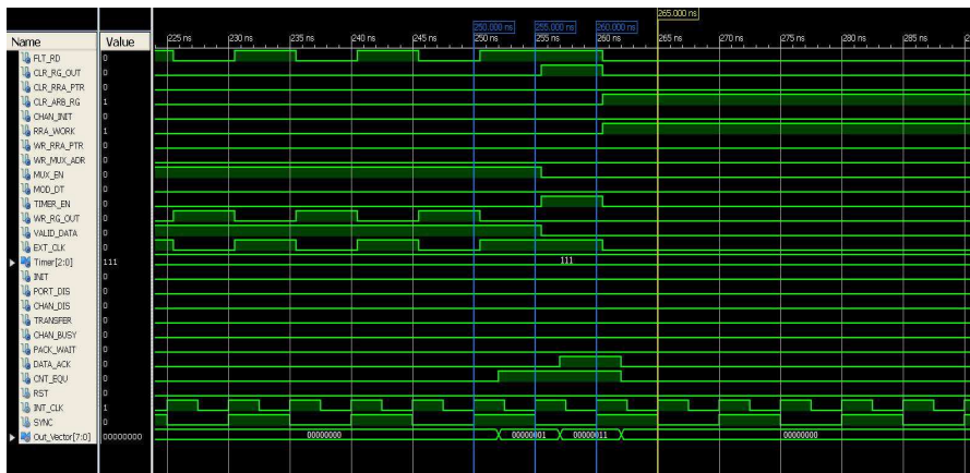
Фиг.4.22. Времедиаграма за край на предаване на пакет от изходен канал към входен буфер на съседен маршрутизатор с потвърждение на успешен трансфер
