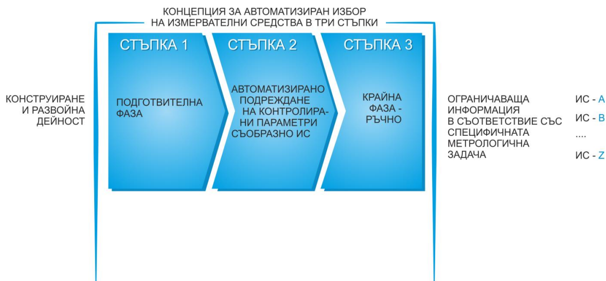
Фиг. 3.7 Концепции за автоматизиран избор на измервателни средства в три стъпки
