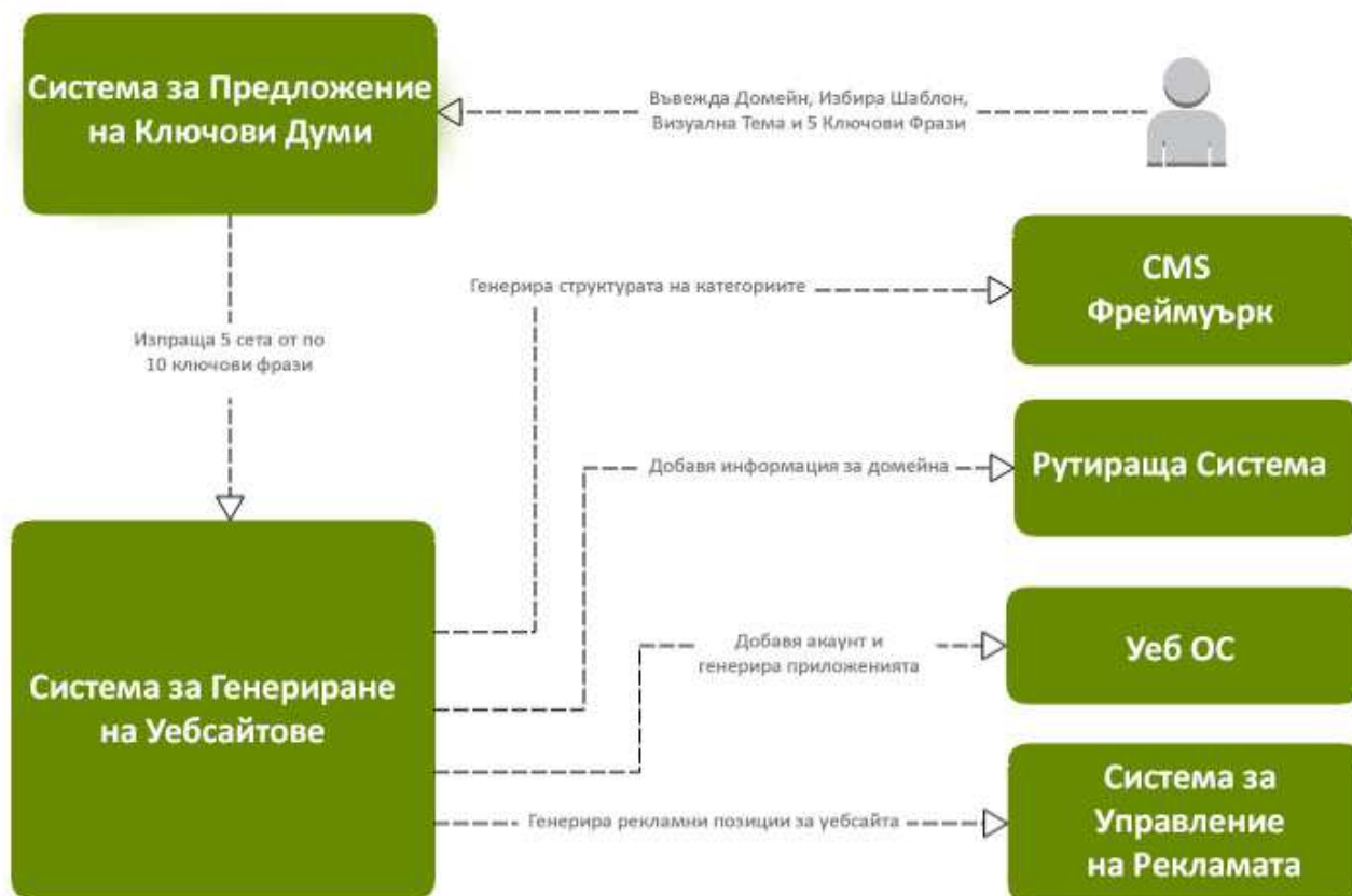
Фигура 5. Архитектура на ССУ в частта на създаване на уебсайта
