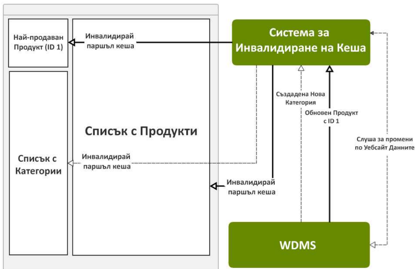
Фигура 9. Архитектура на система за динамично инвалидиране на кеш, подсистема от системата за кеширане на уебсайтове
