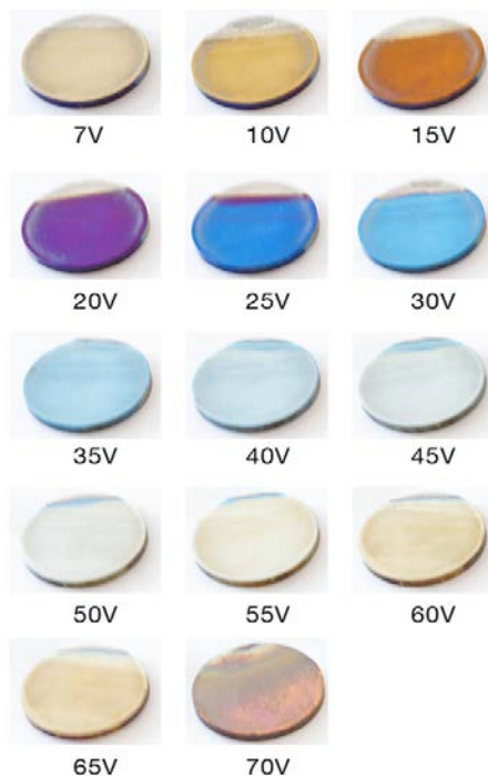
Фиг. 2. Анодирани образци от Ti-6Al-7Nb при различни напрежения. Резултати от първа фаза на предварителен експеримент 2
