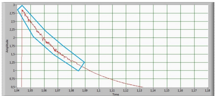
Фиг. 38. Случайни смущения и флуктуации оказващи влияние върху основния ток в началото на реакцията.
