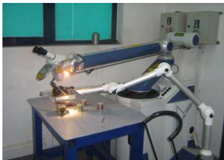
Фиг.2. Апарат за лазерно наваряване
