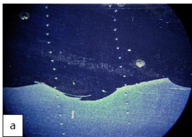
Фигура 20. Наварен слой с EN 550, а) макроструктура; б) наварен слой
