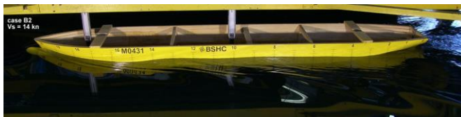
Фигура 7.4.19: Визуализация на вълновата картина за случай на натоварване B2 при скорост 14 възела - моделни изпитвания
