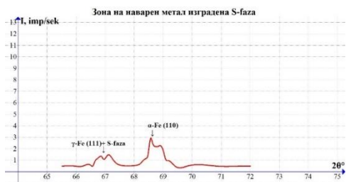
Фиг.37. Рентгеноструктурен анализ на НГАК от ФАС в ЗНМ.
