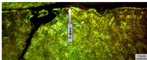
Фиг.38. Микроструктура със формиран фокус, който е в ЗНМ Увеличение X800.
