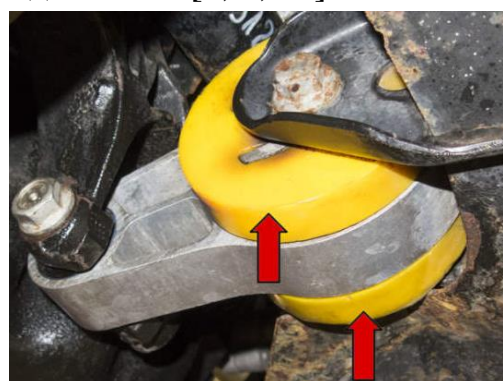
Фиг. 2.5 а) Виброизолатор от уретан – пукнатини от умора
