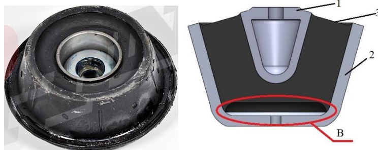
Фигура.2.10. Клинов виброизолатор и технологичния отвор от който зависи характеристиката на виброизолатора.
