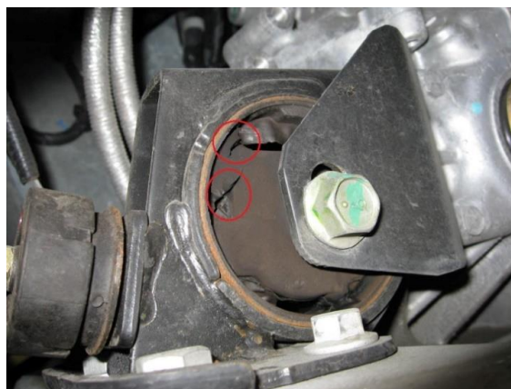
Фиг..2.6 Разпространение на пукнатина в гумения елемент
