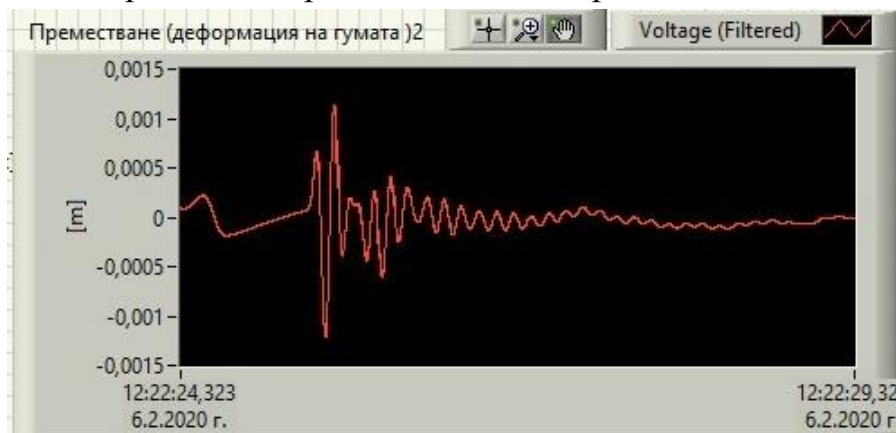
Фиг. 4.43. Затихване на модифициран вариант 1 с твърдост на гърбицата 60^0 Sh при натоварване от 100 [N].
