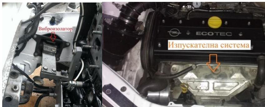
Фиг. 5.1. Разположение на виброизолатора и изпускателната система.
