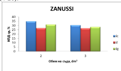
Фиг.4.9. Зависимостта на КПД от обема на използвания съд при различните режими на работа на електрическа фурна за вграждане ZANUSSI модел „BMX316“. (2) – съд с обем 2dm^3 ; (3)- съд с обем 3dm^3 .
