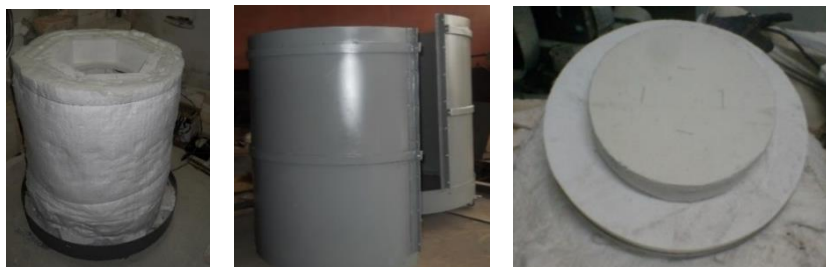
фиг. 2.28 Високотемпературна изолация, корпус и капак
