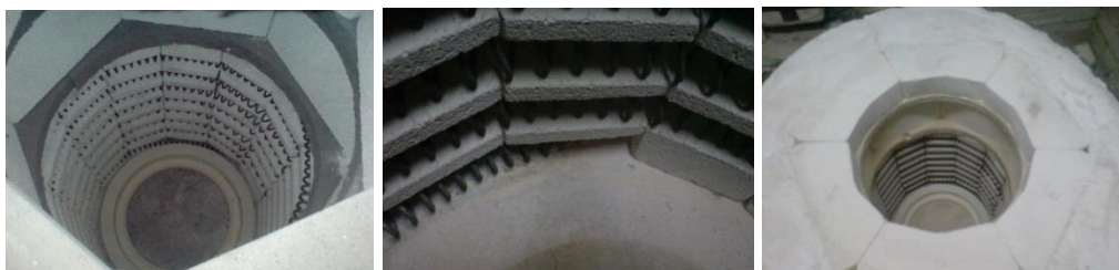
фиг. 2.26 Нагревателен елемент, носачи и изолация на отвора
