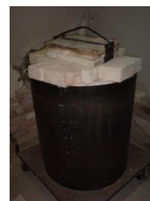
фиг. 2.8 Реализиран опитен образец на малогабаритна стъклотопилна печ
