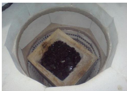
фиг. 2.29 Стъклена скулптура: а – запълнена със стъклени трошки гипсова форма с външен слой от огнеупорен цимент; б – готово изделие.
