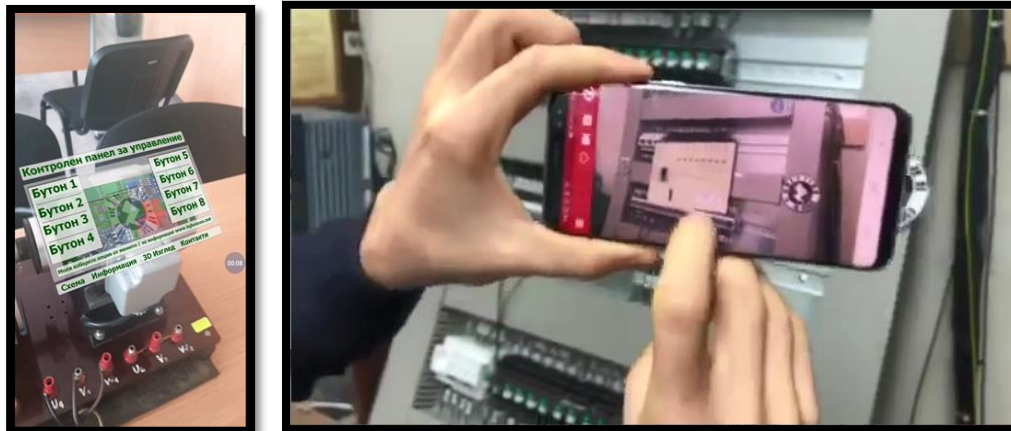
Фигура 5, Снимки на изобразяването на готовия контролен панел за практическото решение с разширена реалност
