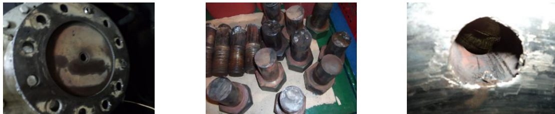
Фиг. 4.2. Дефектирани съединителни фланци и болтове, м/к „Hagen“
