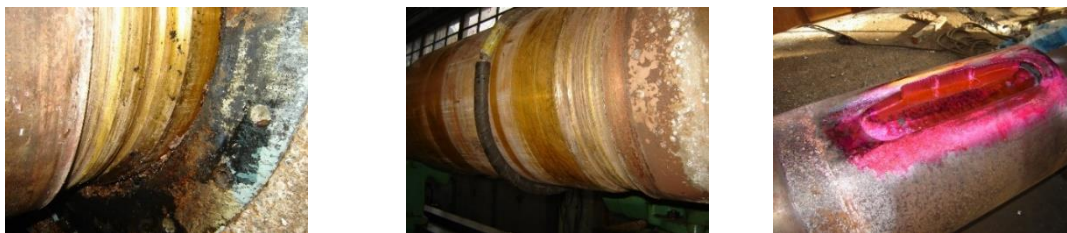
Фиг. 3.2. Дефекти на гребен вал и дейдвудни лагери на м/к „Saint Fanouris“
