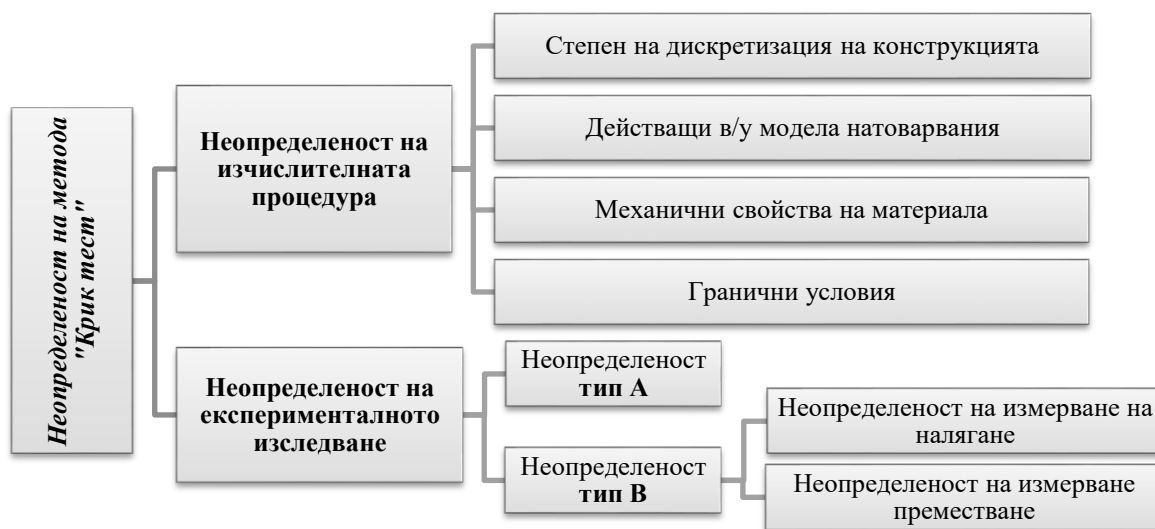
Фиг. 2.3. Блок-диаграма за анализ на неопределеността при измерване на товарването на лагерите на корабни валопроводи по метода „крик тест“
