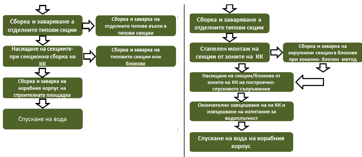
Фиг. 36. Етап 2 от строителството на кораба. Класическа схема (в ляво) и приложима за МСП (в дясно)
