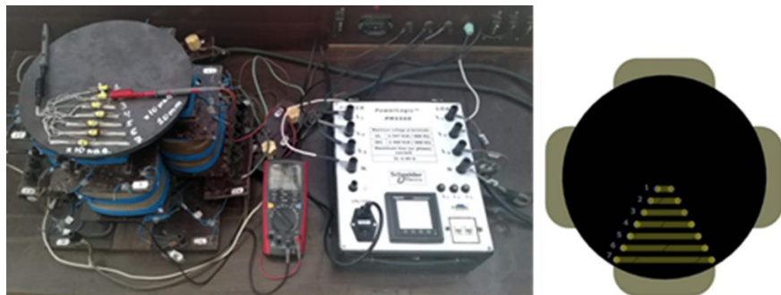
Фиг. 5-10. Опитна постановка за провеждане на експериментални изследвания под товар за отчитане на магнитната индукция и разположение на измервателните сонди върху диска
