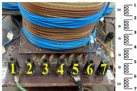
Фиг. 3-6. Бобина на разцепената фаза с изводите на шестте секции и брой на навивките между изводите
