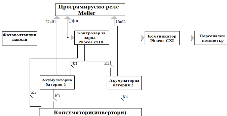
Фигура 3.1. Автономна фотоволтаична система с две акумулаторни батерии
