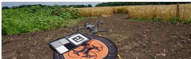
Фиг. 3.3.2. Снимка на DJI Mavic 2 Pro оборудван с камера MAPIR Survey3W_RGN, и калибратор за изображението MAPIR.
