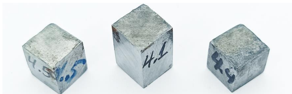
Фиг. 4.33. Образци, подложени на изпитания за електрохимична корозия
