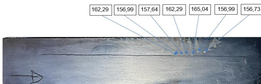
Фиг.4.15. Обр. 3.0 – Твърдост HV5 на основен материал на тестовата тръба
