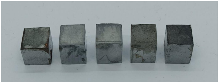
Фиг.4.39. Образци, подложени на изпитания за устойчивост на електрохимична корозия от модела на тръбопровода.
