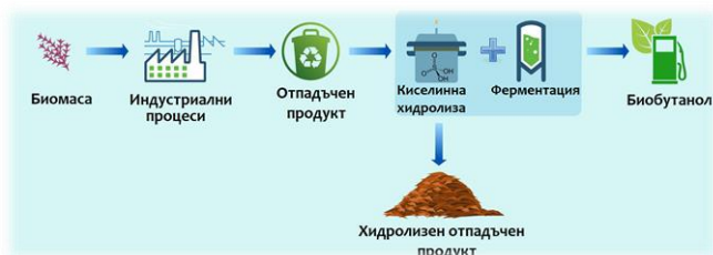
Фигура 1.6. Принципна схема на производство на биобутанол
