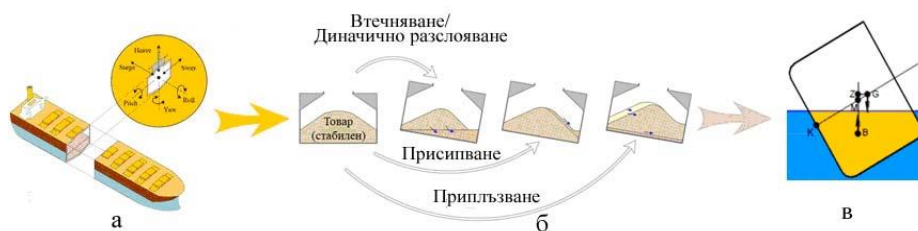
Фиг.6. Принципна схема на сценарий на АМС в резултат на отказ в обекта на управление на системата КОС: а) въздействие върху обекта на управление; б) вариативни възможности за отказ; в) АМС – загуба на устойчивост, обръщане и потъване на кораба.
