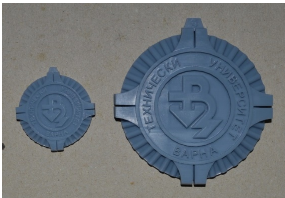
Фигура 59. Принт от Anycubic Photon Mono X 6K принтер с Wanhao 3D Printing Resin Grey (фигура на автора)
