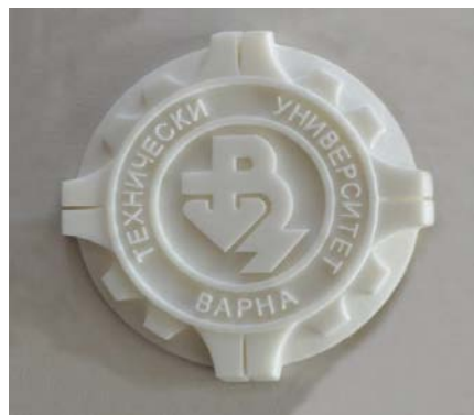
Фигура 65.3. Вариант.IV / размери \Phi 95мм. Принт от Anycubic Photon Mono X 6K принтер с Wanhao 3D Printing Resin White (фигура на автора)
