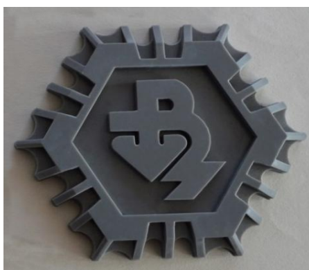
Фигура 65.1. Вариант. II / 100x110мм. Принт с Anycubic Photon Mono X 6K принтер с Wanhao 3D Printing Resin Grey (фигура на автора)
