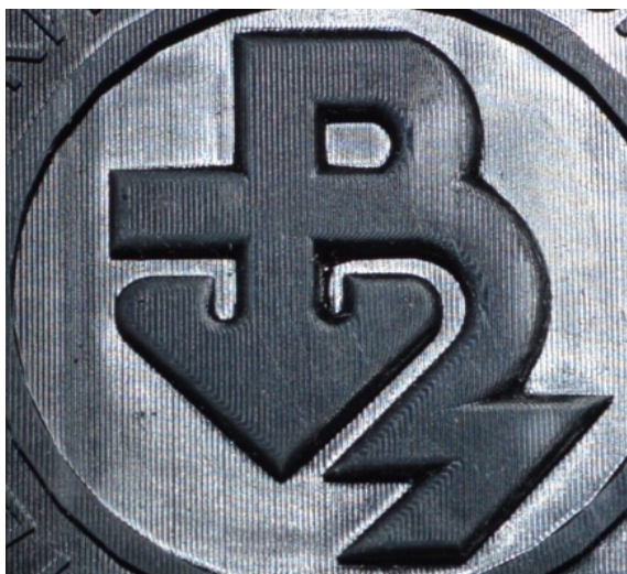
Фигура 63. Следи с втвърдени слоеве смола. Принт с PRIMA VALUE DLP resin Black (фигура на автора)
