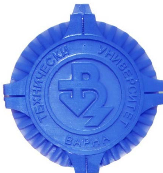
Фигура 66. Модел от восъчна смола. Принт с Anycubic Photon Mono X 6K принтер с Liqcreate Wax Castable (фигура на автора)
