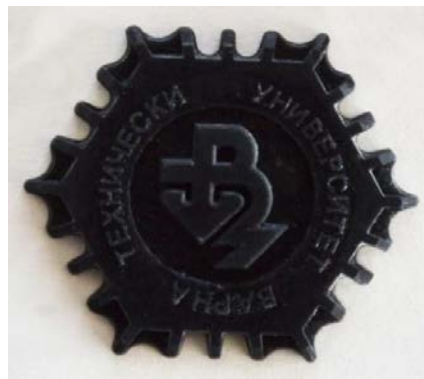
Фигура 65.2. Вариант. III / 530 x 600мм. Принт от Anycubic Photon Mono X 6K принтер с PRIMA VALUE DLP resin Black (фигура на автора)
