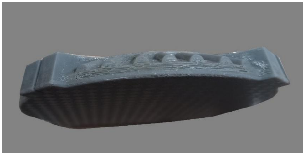
Фигура 55. 3D печат с Anycubic Photon Mono X 6K принтер с Wanhao 3D Printing Resin Grey, в профил се виждат недобре прилепналите слоеве (фигура на автора)
