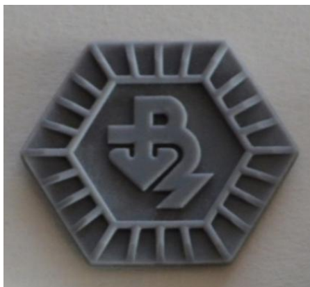
Фигура 65. Вариант. I / 35x40мм. Принт с Anycubic Photon Mono X 6K принтер с Wanhao 3D Printing Resin Grey (фигура на автора)
