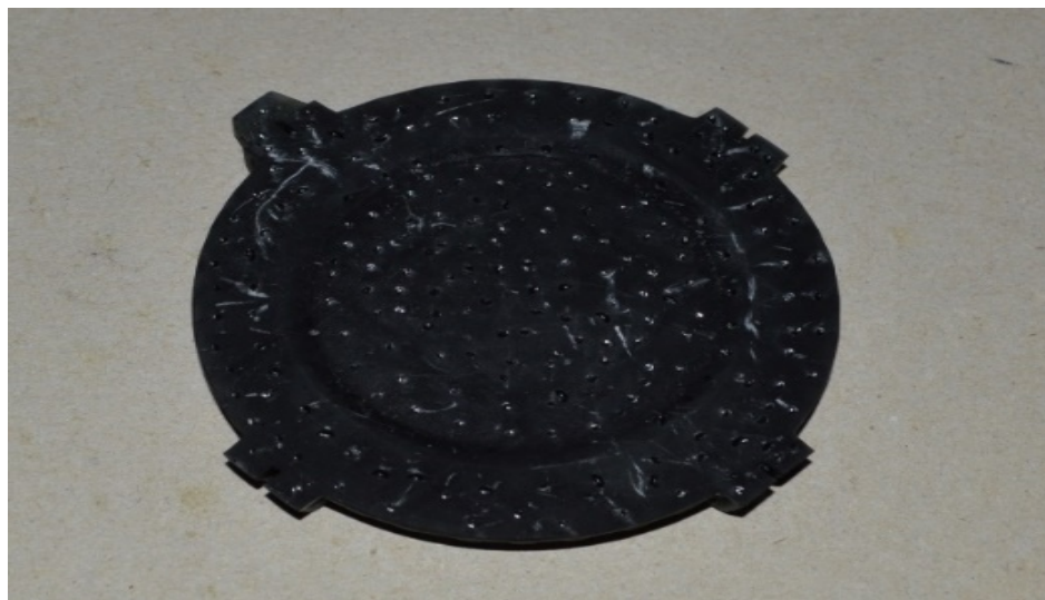
Фигура 64. Гръб - след премахване на опорите. Принт от Anycubic Photon Mono X 6K принтер с PRIMA VALUE DLP resin Black (фигура на автора)
