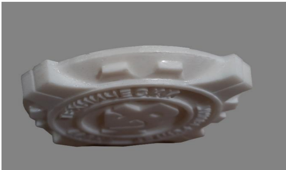
Фигура 60. 3D печат с Anycubic Photon Mono X 6K принтер с Wanhao 3D Printing Resin White, при който в профил слоевете са добре прилепнали (фигура на автора)
