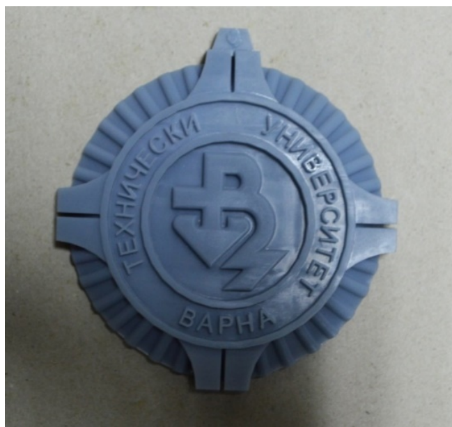
Фигура 54. 3D печат от Anycubic Photon Mono X 6K принтер с Wanhao 3D Printing Resin Grey (фигура на автора)
