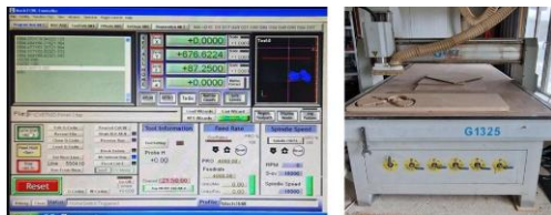
Фигура 27 Данни от софтуера, управляващ цифровата фреза
