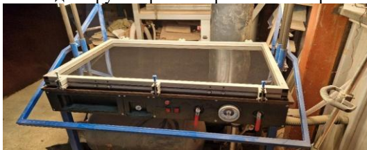
Фигура 30 Листът полистирол, поставен в рамката на машината за вакуумно формоване
