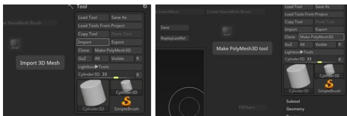
Фигура 17 Импортиране на сканирания модел и преобразуване в PolyMesh3D
