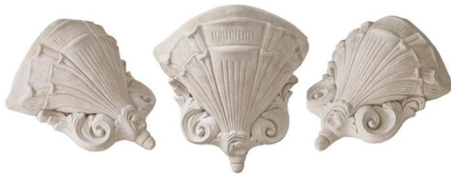
Фигура 33 Завършена отливка от полимербетон
