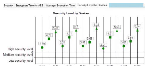
Фиг. 3.65 Ниво на сигурност при различни размери на AES wrap ключове в мрежа с 15 крайни устройства – експеримент 3
