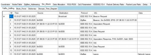
Фиг. 3.77 Прехванат и дешифриран трафик в симулационна среда с командата „Leave“
