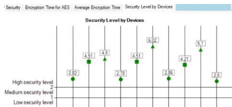
Фиг. 3.64 Ниво на сигурност при различни размери на AES wrap ключове в мрежа с 10 крайни устройства – експеримент 3
