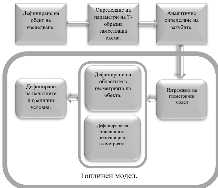
Фиг. 2-1. Алгоритъм за моделиране на температурното поле в асинхронен двигател.
