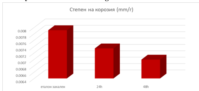
Фиг. 3.25. Сравнителна диаграма на изменение на степента на корозия при сплав AlSiMgMn
