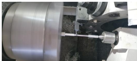
Фиг.2.5. ППД с диамантен накрайник на цилиндрични образци върху струг с ЦПУ
