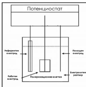
Фиг.2.7. Принципна схема на електрохимична корозия
