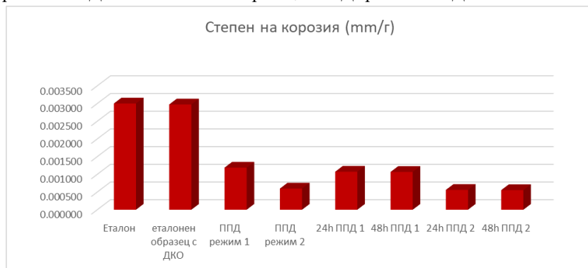
Фиг. 3.59. Сравнителна диаграма на изменение на степента на корозия при сплав AlMg4,5
