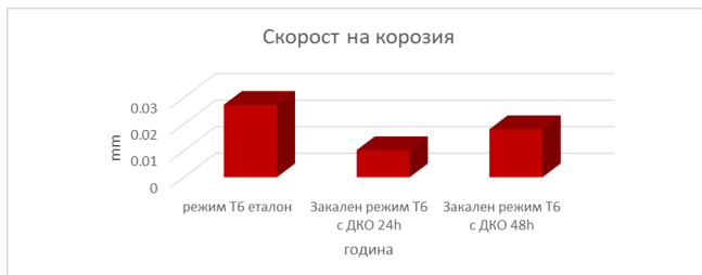
Фиг. 3.10. Сравнителна диаграма на изменение на скоростта на корозия при сплав AlSi7Mg
