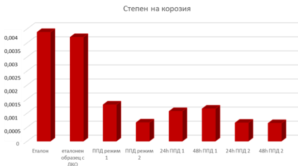
Фиг. 3.42. Сравнителна диаграма на изменение на степента на корозия при сплав AlMg6
