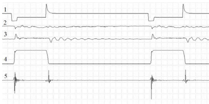
Фиг. 4.10 Последователни работни цикли при еквивалентна честота на въртене на колянния вал на двигателя 1000 min -1
