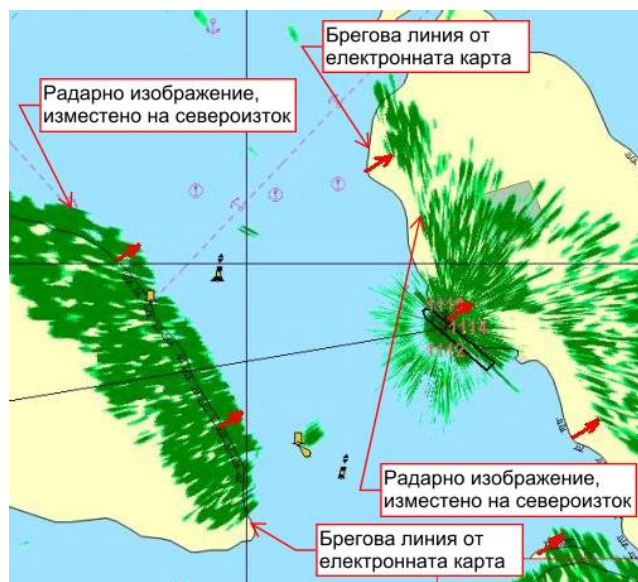
Фиг. 1.11 – Изместване на радарно изображение, показващо неточности в данните постъпващи от GPS приемника
