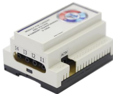
Фиг.3.4. Модул за измерване на ток и напрежение с 4-ри токови трансформатора в диапазон 0÷100А: а) Изглед отвътре; б) Изглед отляво
