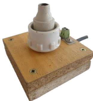
Фиг.3.3. Приспособление за запояване на термодвойка тип К
